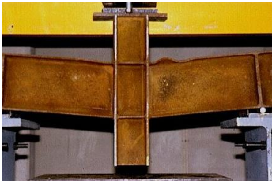
Lokalna utrata stateczności pólki słupa stalowego (STR LS)
