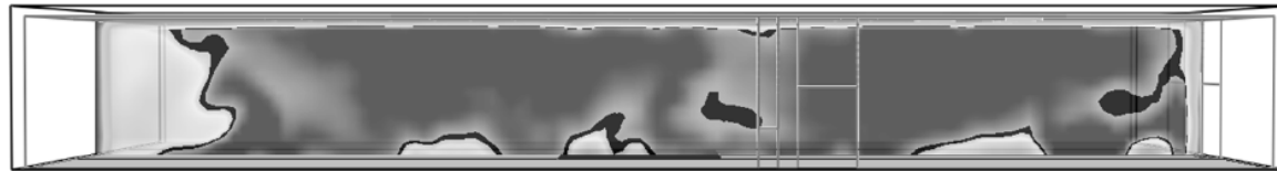
Rys. 5. Model MF2. Rozkład wartości temperatury po 11 minutach trwania pożaru. Pogrubioną linią oznaczono izotermę 690°C
